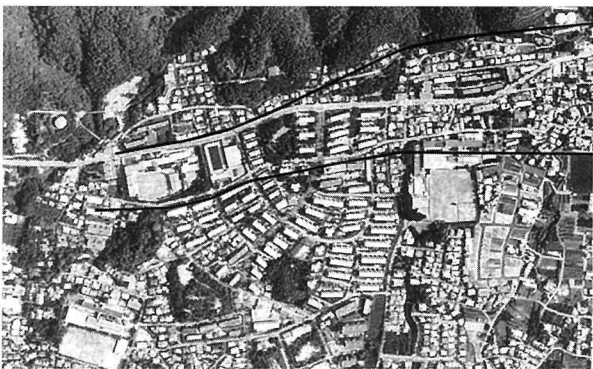
航空写真上に描かれた活断層の高精度位置図の例(中田高氏作成)。画面上部に左から右端へ延びる2本の太線が活断層。
