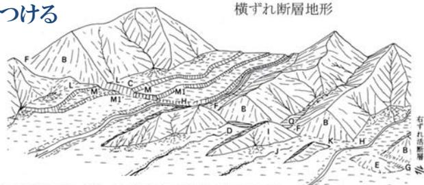
A: 拗曲崖, B: 三角末端面, C: 低断層崖, D: 断層池, E: ふくらみ, F: 断層鞍部, G: 地溝, H: 横ずれ谷, I: 閉塞丘, J: 截頭谷, K: 風障, L-L': 山麓線のくいちがい, M-M': 段丘崖(M, M')のくいちがい, Q: 堰止めの池.
