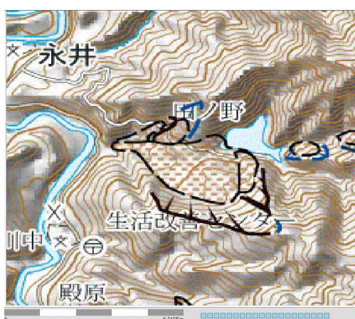
図4 1889年の豪雨で生じた奈良県十津川村永井の地すべり地形 4) 付近の斜面崩壊 (33.96617° N, 135.74199° E)
